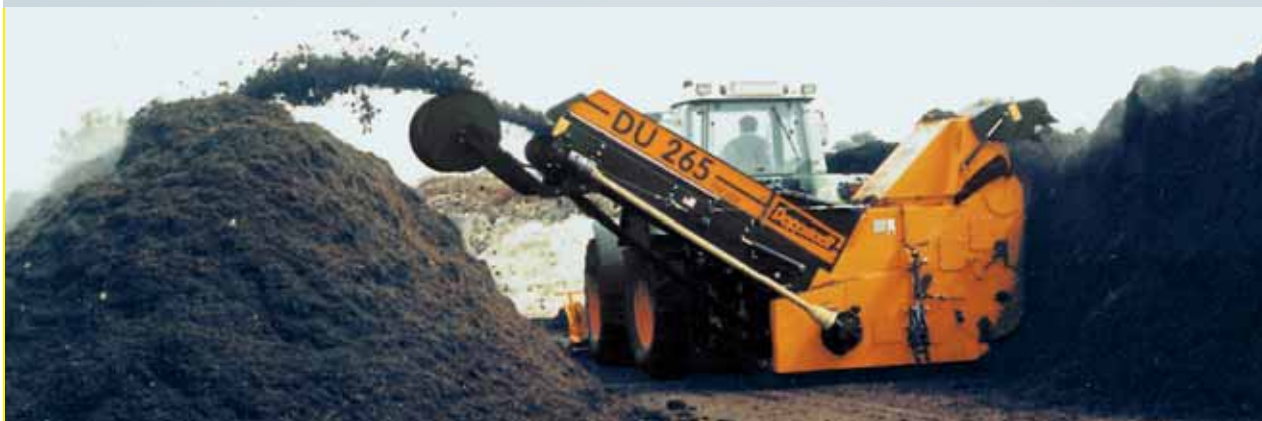
Retournement et aération d'un andain
